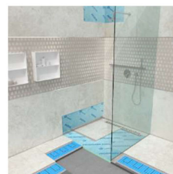
Figura 19: Impermeabilizzazione doccia a pavimento. Fonte: https://www.ilgiornaledeltermoidraulico.it/soluzioniper-docce-a-filo-pavimento/
